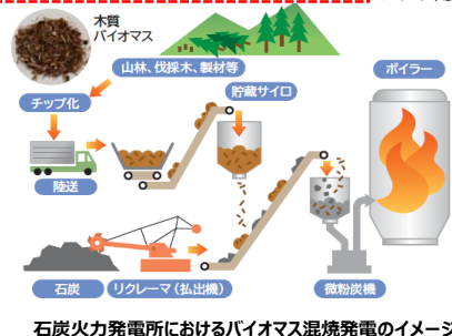
石炭火力発電所におけるバイオマス混焼発電のイメージ
