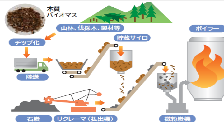
石炭火力発電所におけるバイオマス混焼発電のイメージ
