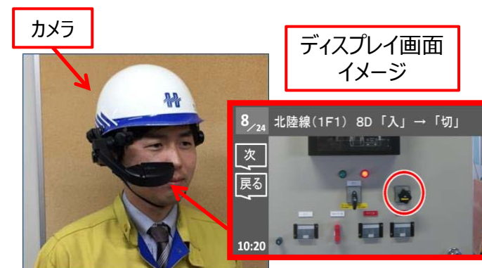
ウェアラブルカメラ・モニターによる遠隔支援の検証例
