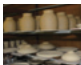
成形完成。この後、乾燥・素焼き・下絵付けなどをして、窯で本焼きを行う
