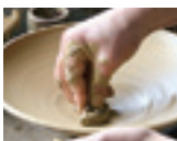
「コテ」で表面をならす。土の粒子を締める作用もある
