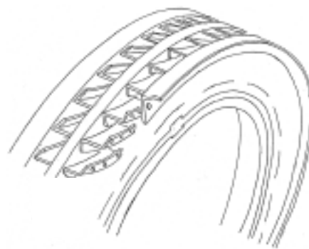
コレクタリング冷却ファン概要図
