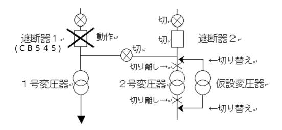
2号変圧器から仮設変圧器への切り替え作業を行い、確認試験を実施していたところ、試験回路の接続誤りにより、遮断器1が動作して停電した。
