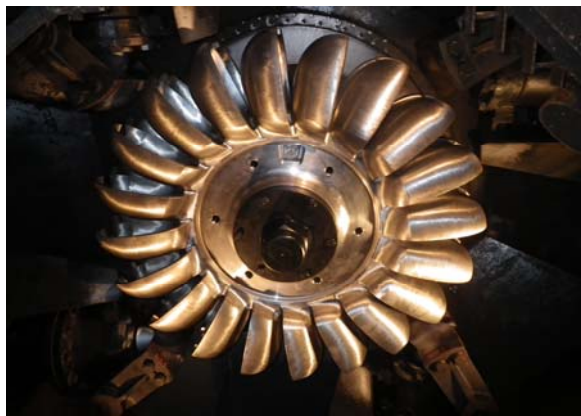
滝波川第一発電所 水車ランナ
