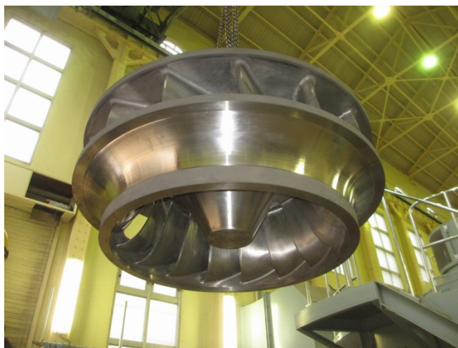
吉野谷発電所 水車羽根車（ランナ）
