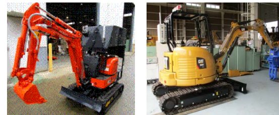
小型・大型無線重機 （屋外の瓦礫等の除去）
