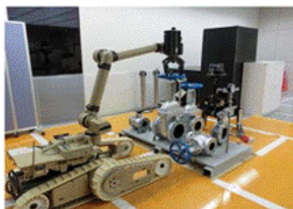
バルブの開閉操作
