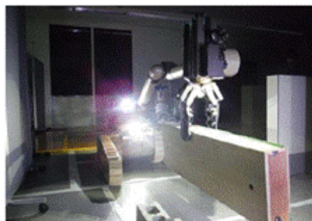
暗闇での障害物撤去
