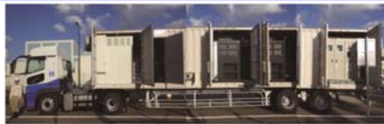
可搬型窒素供給装置の設置
