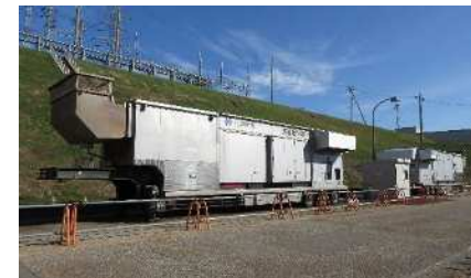
大容量電源車 [4,000kVA]
