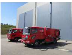
可搬型低圧注水ポンプの配備
